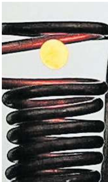
Prinzip der Levitation: Erhitzte Metallkugel schwebt frei TU GRAZ
